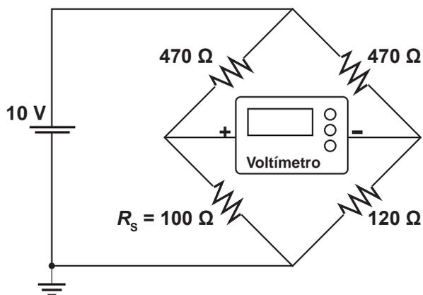
Para um valor de temperatura em que  $R_s = 100 \Omega$ , a leitura apresentada pelo voltímetro será de
